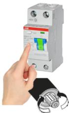
1. Conectar el motor en el que se va a grabar el mando a corriente
