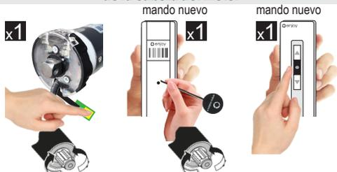
Con el motor conectado en corriente
